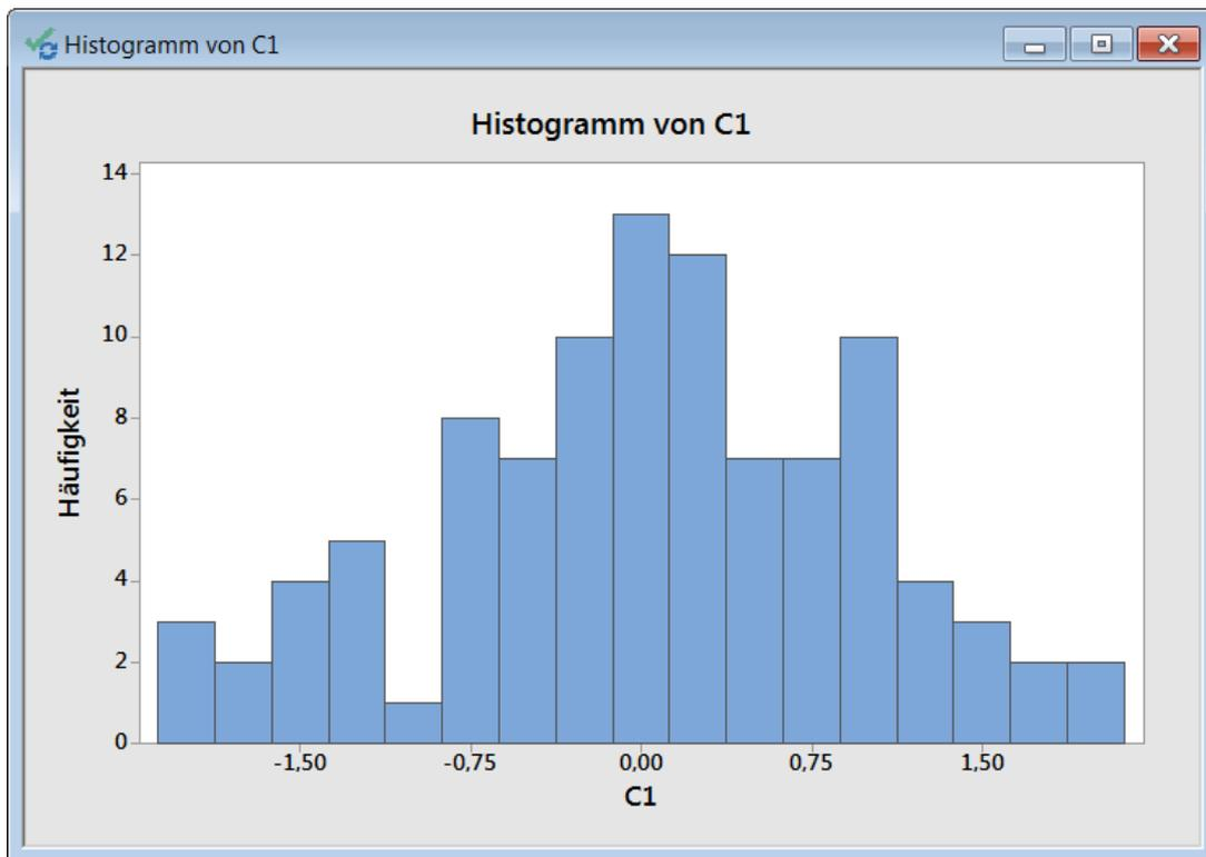
Vor dem Erstellen der Spalte mit den Farbkodierungen müssten Sie die Balken zählen, oder einen Doppelklick auf die x-Achse machen, um die **Anzahl der Intervalle** im Dialogfeld **Skala bearbeiten** abzulesen.
