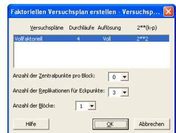
ein vollfaktorieller Versuchsplan mit vier Durchläufen. Ein zweistufiger Versuchsplan mit zwei Faktoren verfügt über  $2^2$  (d. h. vier) mögliche Faktorkombinationen.
