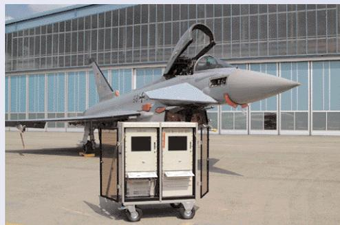
Eurofighter mit transportabler Testanlage, die bei der kontinuierlichen Wartung und den Upgrades der Prototypen eingesetzt wird
