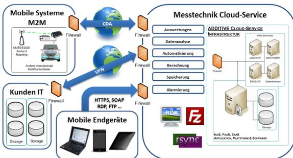
In der Gestaltung als **Messtechnik-Cloud** bieten die ADDITIVE Cloud-Services spezielle Funktionen für die Anforderungen der mobilen und stationären Überwachung von Sensoren und Messsystemen und der M2M-Kommunikation.
