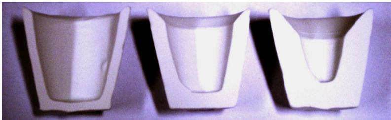
Abbildung 7: Beispiele halbiertes Tiegel nach 2, 5 und 10 min Standzeit
