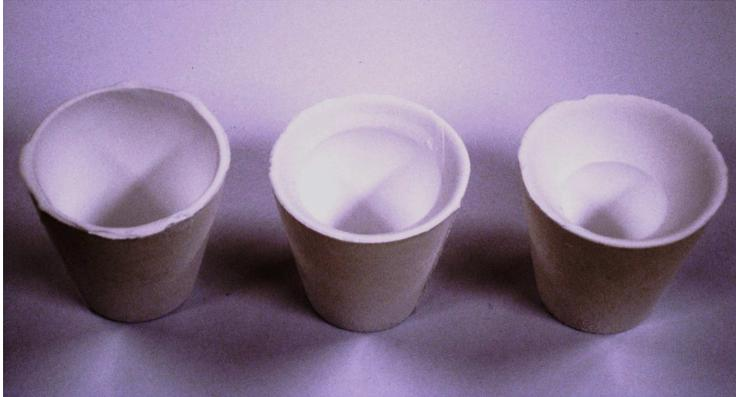
Abbildung 4: Beispiele für getrocknete Tiegel nach 2, 5 und 10 min Standzeit
