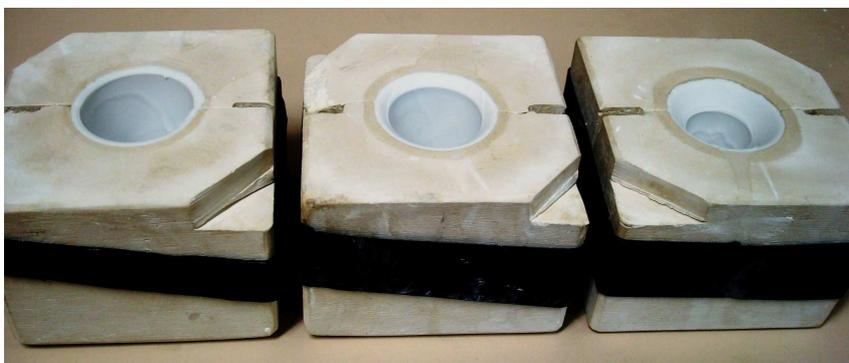
Abbildung 3: Beispiele für runde Tiegel nach 2, 5 und 10 min Standzeit
