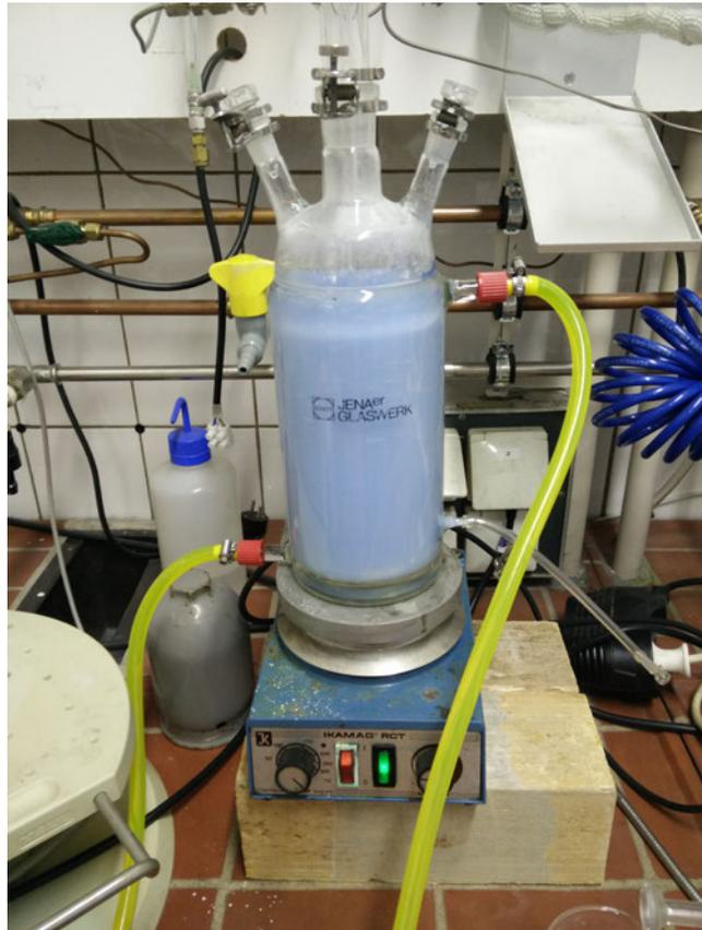
*Abb. 10: Doppelwandreaktor mit Magnetrührer und Indikator*
