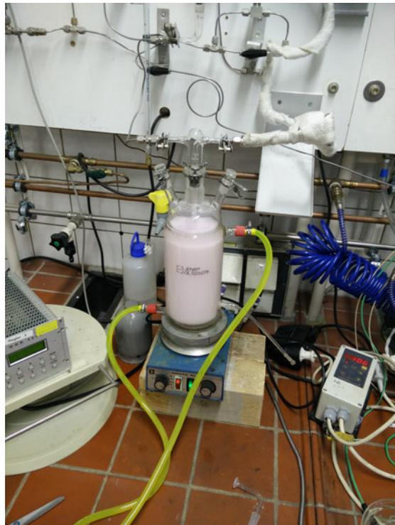
Abb. 15: Doppelwandreaktor mit gesättigter Lösung
