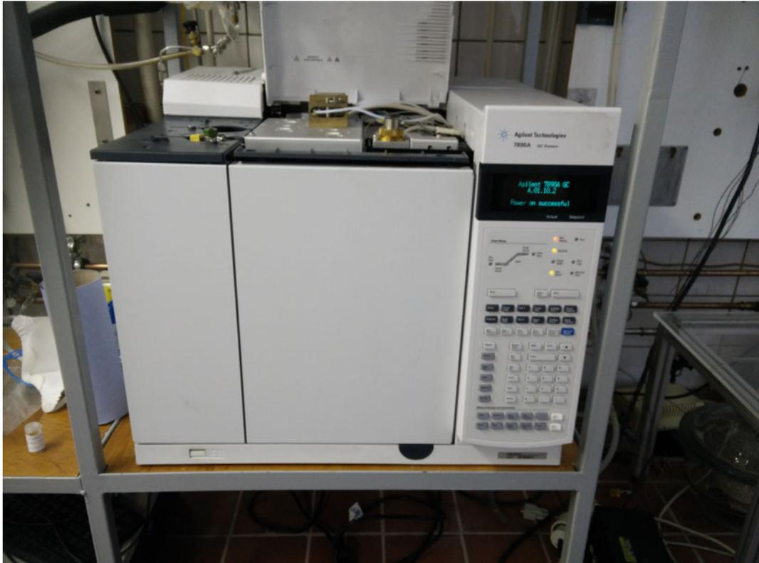
Abb. 14: Gaschromatograph (GC 7890A System)
